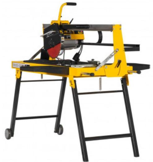
Die besonders robuste Steintrennmaschine STM350-1200PRO ist vielseitig einsetzbar, geeignet für das Schneiden von Feinsteinzeug, Granit, Klinker, Marmor, Terrazzo, Naturstein und Betonstein.
