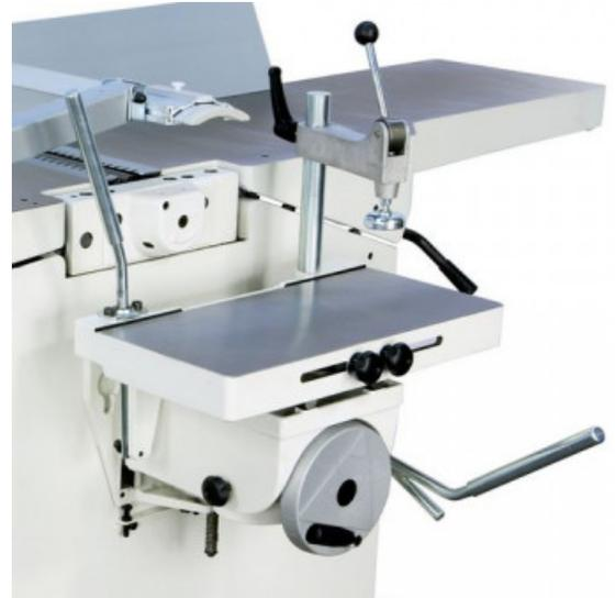
Zum einfachen Herstellen von Nuten, Zapfenlöchern und Steckverbindungen
