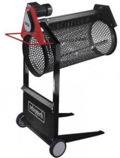
DAS rs 400 LÄSST IHNEN NICHTS DURCHGEHEN, WAS IHNEN ZU GROB ERSCHEINT. SIE VERFEINERN GROSSE MENGEN UNTERSCHIEDLICHSTER MATERIALIEN WIE VON ZAUBERHAND. DER EINSTELLBARE NEIGUNGSWINKEL DER SIEBTROMMEL, SOWIE DIE UNTERSCHIEDLICHEN MASCHENWEITEN DIE SIEBE ERLEICHTERN IHNEN DAS SIEBEN UNTERSCHIEDLICHER MATERIALIEN.
